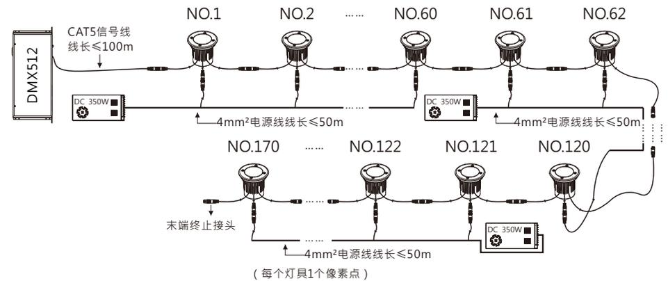
注:DMX控制,每个电源单回路可并联60个灯具,且电源连接灯具总数量不要超过电源功率的80%。
