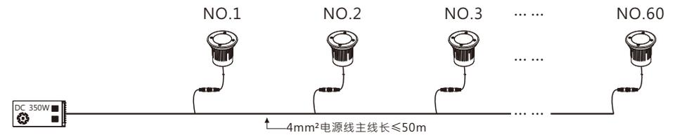
注:单色常亮,灯具每个电源单回路可并联60个灯具,且电源连接灯具总数量不要超过电源功率的80%。
