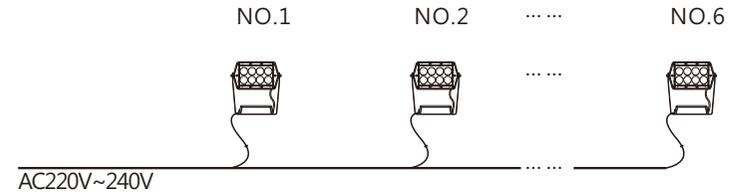
注:单色常亮,每个电源回路可并联6个灯具,且电源单回路连接灯具总功率不超过1000W。
