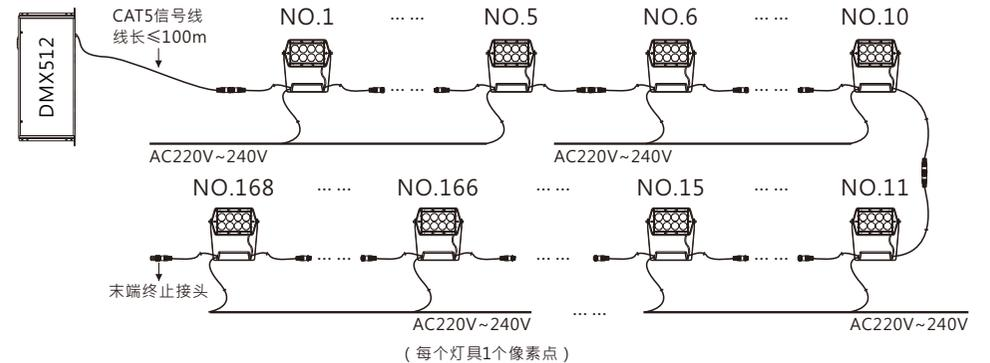
注:DMX控制,灯具每个电源回路可并联5个灯具,且电源单回路连接灯具总功率不超过1000W。
