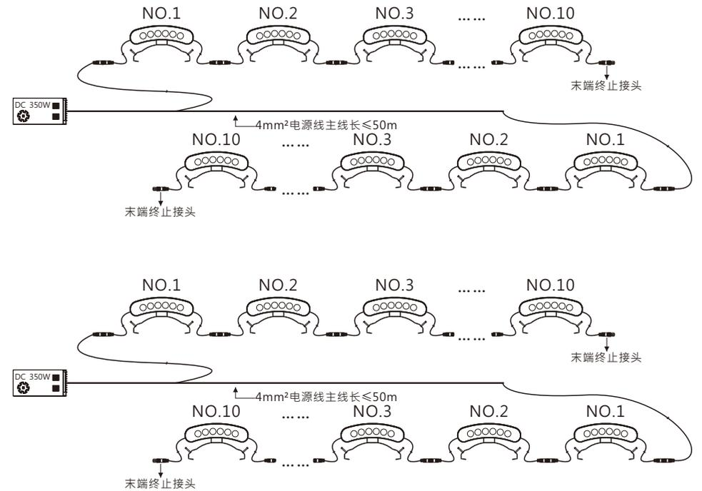
注: 单色常亮·灯具每个电源单回路可串联10个灯具·且电源连接灯具总数量不要超过电源功率的80%·
