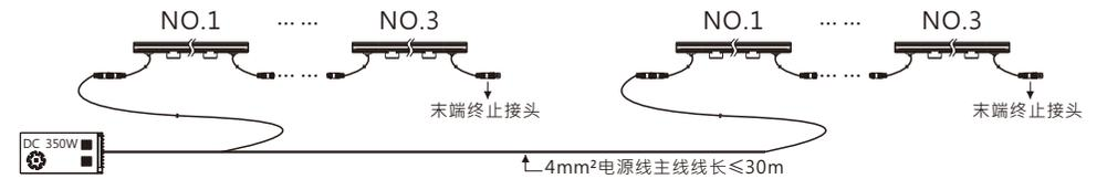
注:单色常亮·灯具每个电源单回路可串联3支灯具·且电源连接灯具总数量不要超过电源功率的80%。
