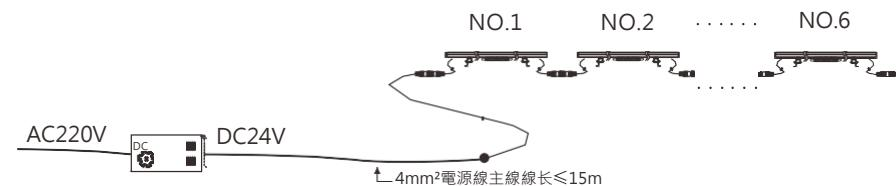
注：單色常亮，每支燈具邊蓋單邊出線≤100mm，每個電源單回路可串聯6支燈具（單支燈具15W），建議電源回路連接燈數總功率不超過電源最大功率的80%。
