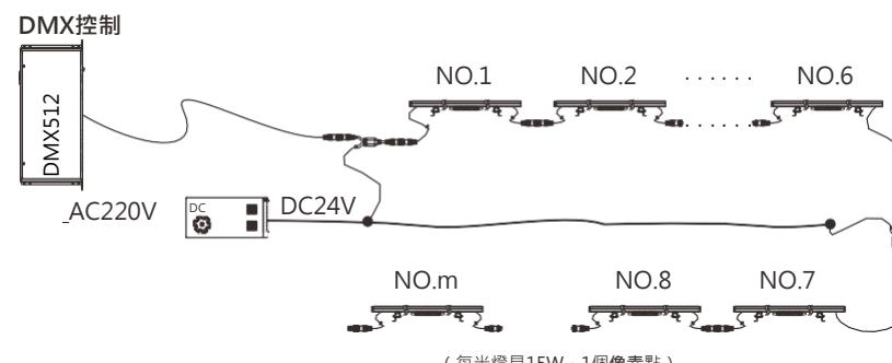
注：電源回路4mm<sup>2</sup>電源線主線，電源線到首燈長度不超過15米。每只燈具1個像素點，邊蓋單邊出線≤100mm，電源回路單串可串接6支燈具，總負載30支。
