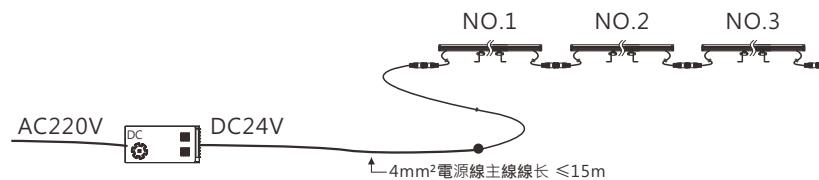
注：單色常亮，每支燈具邊蓋單邊出線≤100mm，每個電源單回路可串聯3支燈具（單支燈具32W）。
