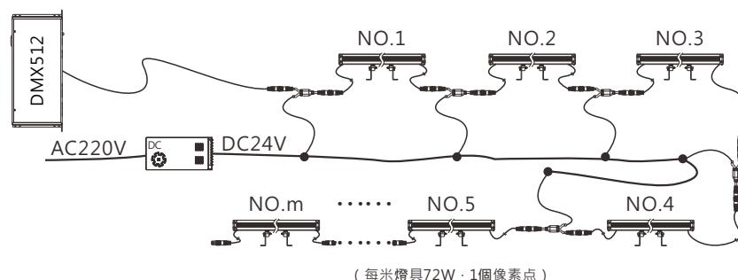
注：電源回路4mm<sup>2</sup>電源線主線，電源線到首燈長度不超過15米。每只燈具1個像素點，邊蓋單邊出線≤100mm。電源回路可並連1支燈具，總負載6支。
