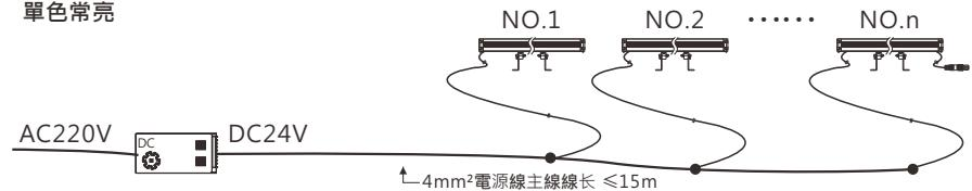
注：單色常亮，每支燈具邊蓋單邊出線≤100mm，每個燈具並聯在電源主線上（單支燈具72W），建議電源回路連接燈數總功率不超過電源最大功率的80%。
